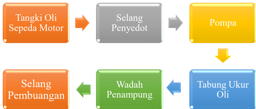
Gambar 2. Prinsip Kerja Alat Penyedot Oli
